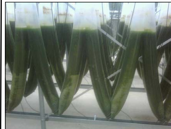
Pilot-Algenanlage im Kraftwerk Niederaußem: Durch stärkere Photosynthese wird mehr Kohlendioxid verbraucht
